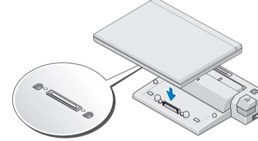
Τοποθετήστε το φορητό υπολογιστή στο κέντρο και επάνω στο E-Port Plus II και σπρώξτε προς τα κάτω για να τοποθετηθεί σωστά
